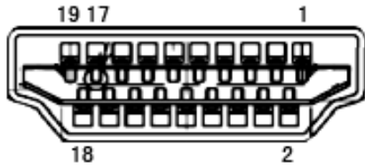
19-контактний кабель кольорового дисплея
