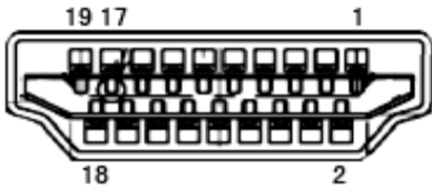
Câble de signal d'affichage couleur à 19 broches
